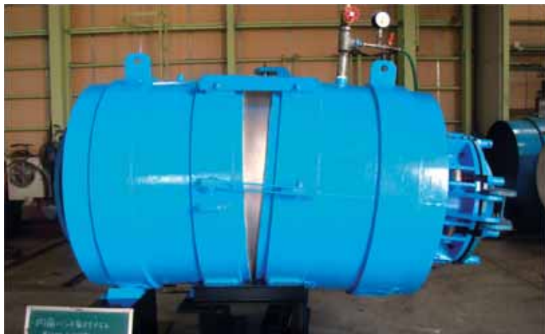
内水圧1.0MPa、曲げ角8度
