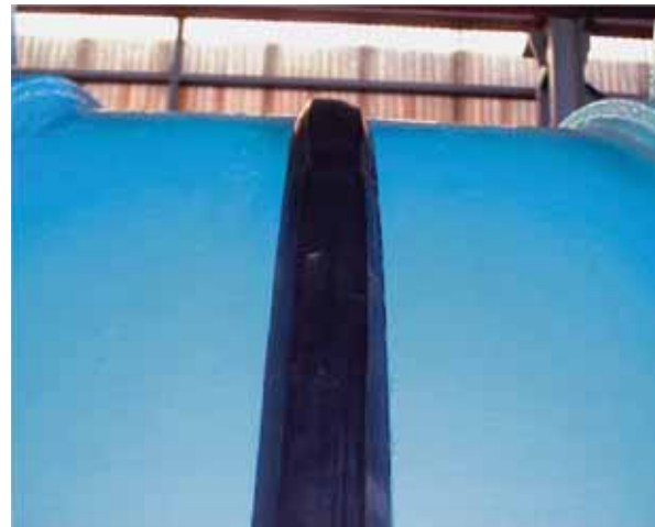
内水圧0.5MPa、継手30mmのゴム膨らみ
