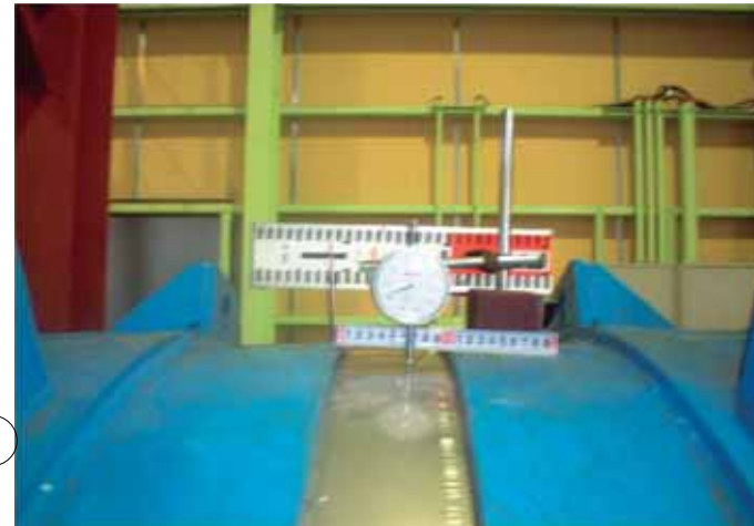
水圧0.8MPa継手間隔100mm
