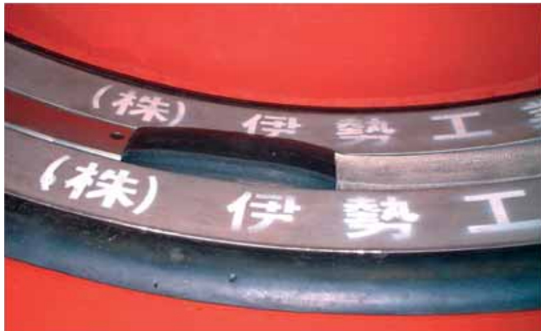
外水圧0.3MPaのゴムと外圧抵抗板
